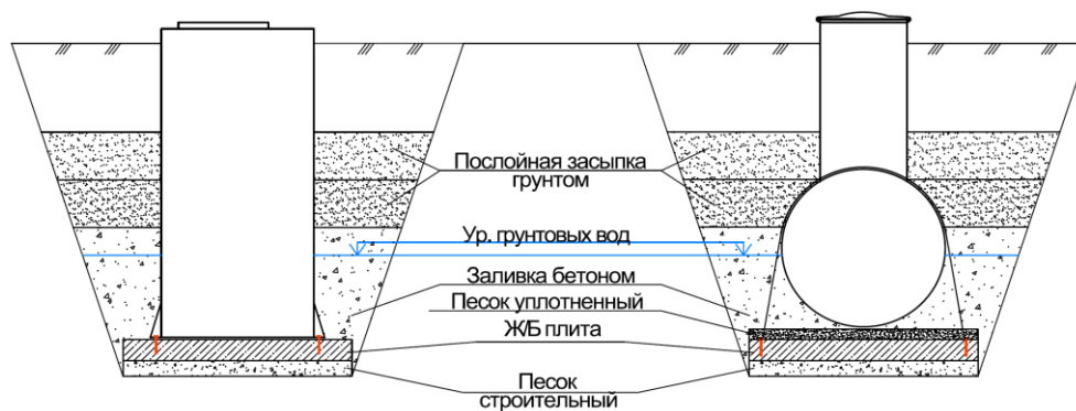
Схема монтажа дренажных тоннелей
